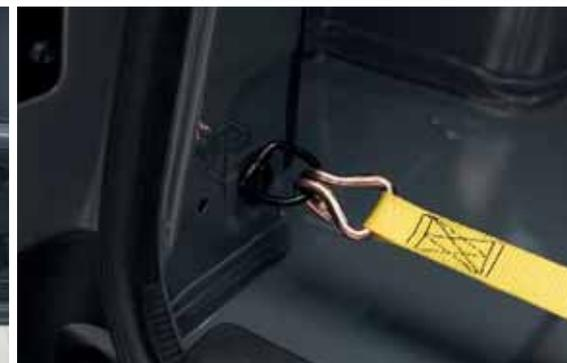
Fino a 18 anelli di ancoraggio sul piano di carico e sui montanti permettono di bloccare gli oggetti trasportati.
