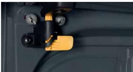
Questo dispositivo permette di bloccare e mantenere aperta la porta posteriore.
