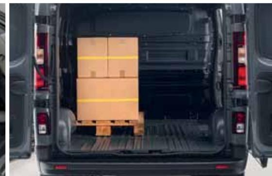
Le porte posteriori incernierate si aprono a 180°/270° e hanno una larghezza di 1,3 m per facilitare l'accesso al vano di carico.
